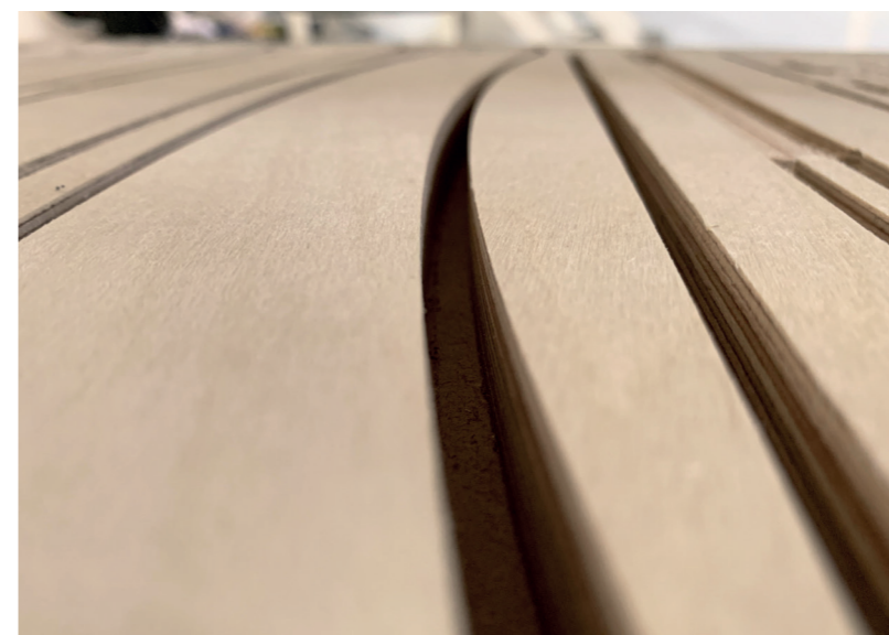
ΠΑΡΑΔΕΙΓΜΑ ΕΦΑΡΜΟΦΗΣ PROJECT: ΚΑΤΑΣΚΕΥΗ ΚΑΡΕΚΛΑΣ ΥΛΙΚΟ: ΚΟΝΤΡΑ ΠΛΑΚΕ (ΣΗΜΥΔΑ)
